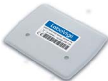
Badge RFID + température 2450 MHz
